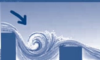
Fallwehr mit Tosbecken
