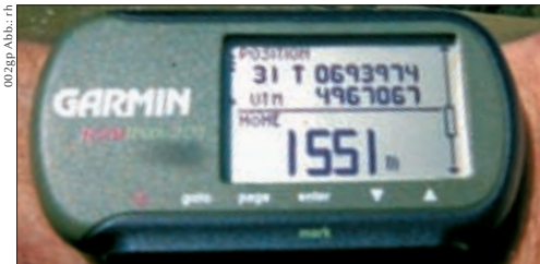
◀ Typische Anzeigeform der GPS-Position (oben) und Höhe (unten)
